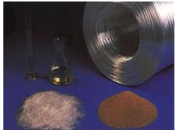
Figure 3 : Matières premières utilisées pour la fabrication de PRV.
